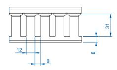
$W = 75 \, \text{mm} / 100 \, \text{mm} / 125 \, \text{mm} / 150 \, \text{mm}$
