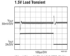
$12V_{\rm IN},\,1.5V_{\rm OUT},\,0A$  TO 4A LOAD STEP AT 4A/µs  $C_{\rm OUT1}$  100µF x4 6.3V X5R CERAMIC 1210 CASE SIZE SWITCHING FREQUENCY 500kHz  $C_{\rm FF}$  CAPACITOR = 47pF
