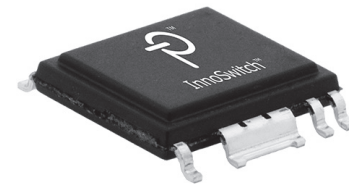
图2. 符合安规的高爬电距离eSOP封装
